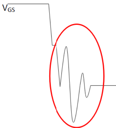
图 7-4：栅极振铃现象
