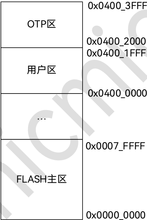
图 4-1：EFC 存储器地址映射
