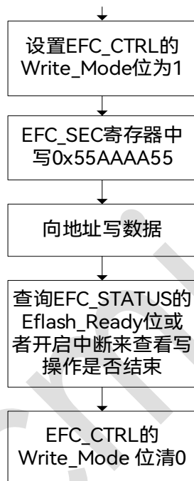
图 6-1: 写操作流程
