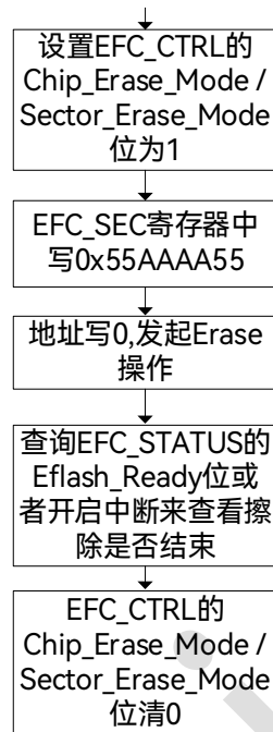
图 6-2: 擦除操作流程
