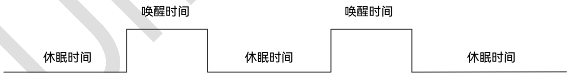
图 6-3：超低功耗接收流程图
