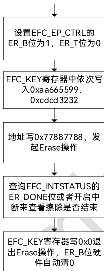
图 6-4: Sector 擦除操作流程
