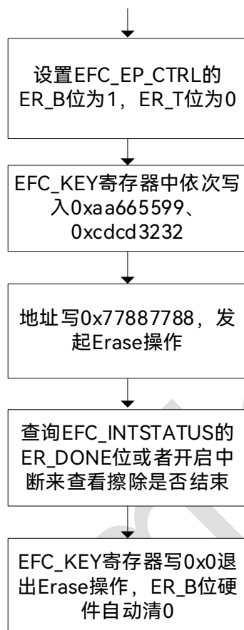
图 6-4: Sector 擦除操作流程
