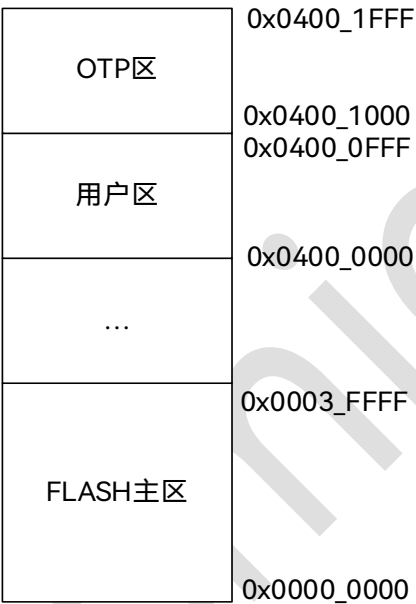
图 4-1：EFC 存储器地址映射
