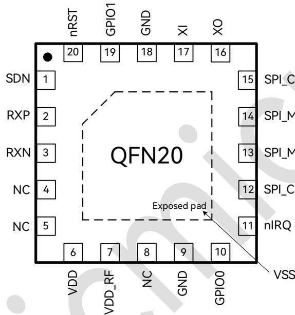
图 3-1: QFN20 封装引脚分布图
