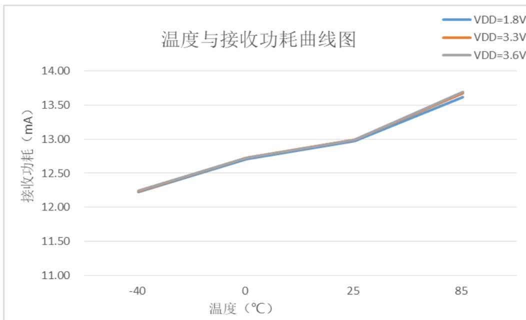
测试条件:  $F_{RF}=915\text{MHz}$ ,  $DR=10\text{kbps}$ ,  $F_{dev}=22\text{kHz}$ ,  $VDD=1.8\text{V}/3.3\text{V}/3.6\text{V}$
