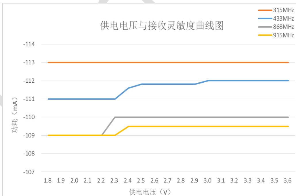
测试条件:  $DR=10\text{kbps}$ ,  $F_{dev}=22\text{kHz}$ , GFSK,  $F_{RF}=315\text{MHz}/433\text{MHz}/868\text{MHz}/915\text{MHz}$
