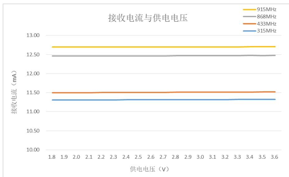
测试条件: DR=10kbps,  $F_{dev}=22\text{kHz}$ , GFSK,  $F_{RF}=315\text{MHz}/433\text{MHz}/868\text{MHz}/915\text{MHz}$
