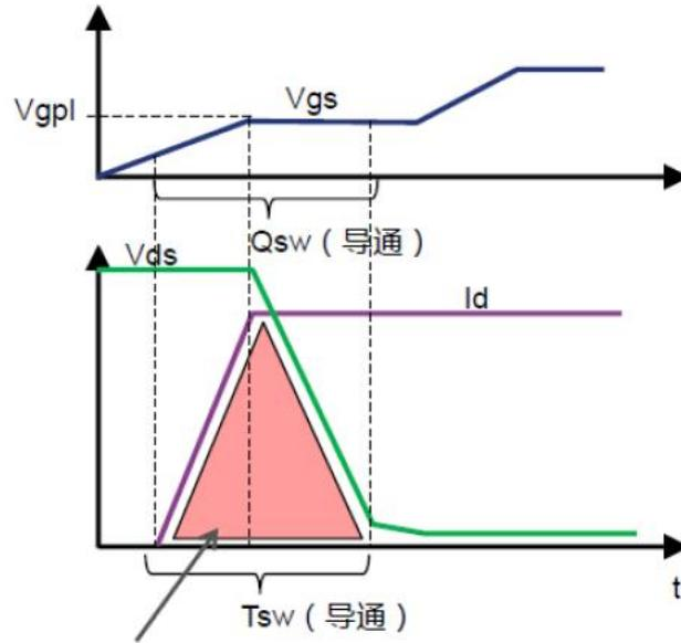
$$P_{sw(on)} = \frac{1}{2} \times I_d \times V_{ds} \times T_{sw(on)}$$
