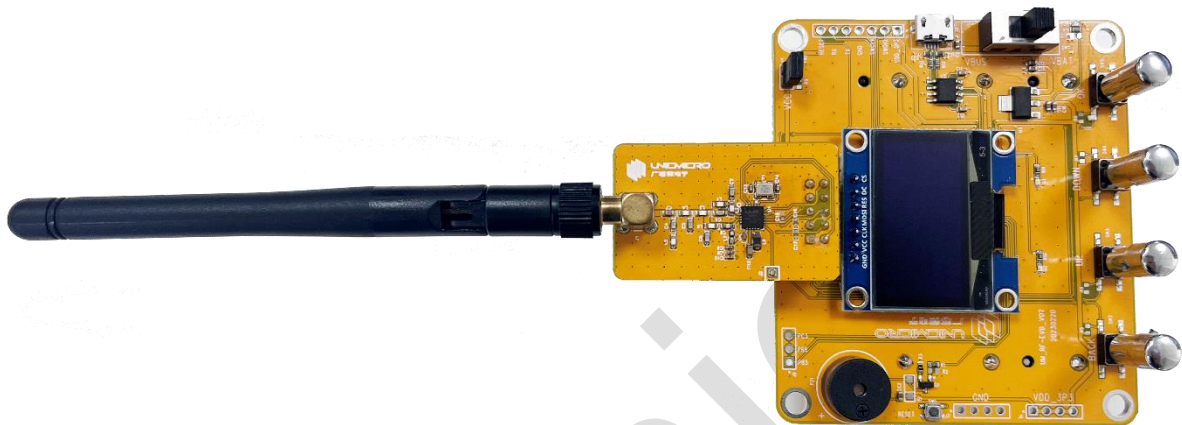
图 2-3: RF-EVB 子板与 RF-EVB 母板连接图
